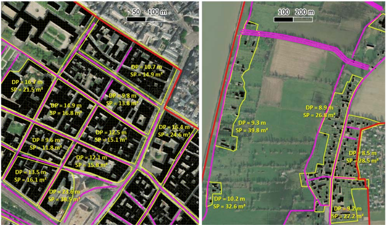
Figure 40- Définition des zones d'application de la méthode de Lindner – Exemples sur les secteurs de Rouen (à gauche) et Saint-Pierre-de-Manneville (à droite)
